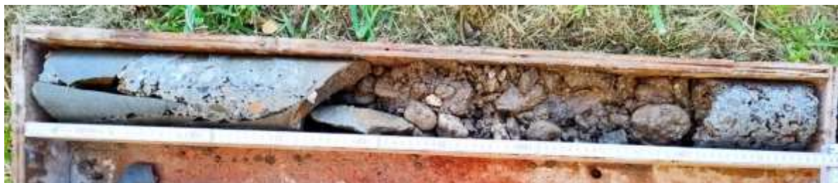
Obr. 13 JV4 – jádrový vývrt 0 – 1,0 m
