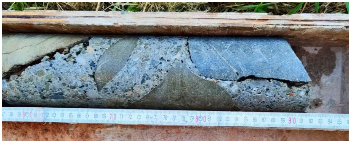
Obr. 9 JV2 – detail jádrového vývrtu 0,6 – 0,9 m
