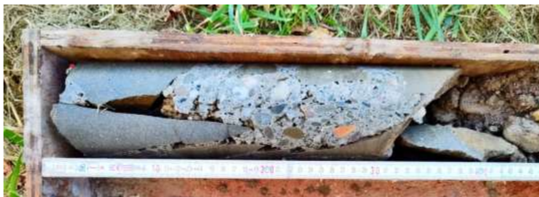
Obr. 14 JV4 – detail jádrového vývrtnu 0 – 0,4 m
