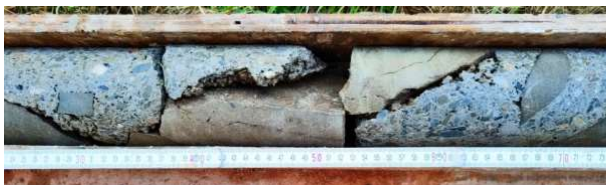
Obr. 8 JV2 – detail jádrového vývrtu 0,4 – 0,7 m
