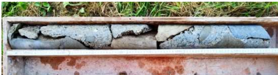
Obr. 6 JV2 – jádrový vývrt 0 – 0,9 m
