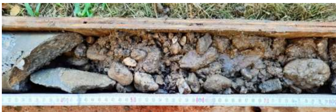
Obr. 15 JV4 – detail jádrového vývrtnu 0,4 – 0,8 m
