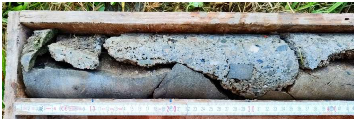
Obr. 7 JV2 – detail jádrového vývrtu 0 – 0,4 m
