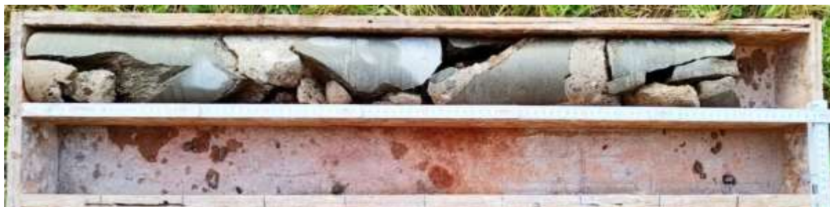
Obr. 3 JV1 – jádrový vývrt 0 – 0,9 m
