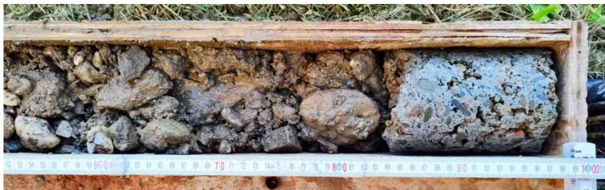
Obr. 16 JV4 – detail jádrového vývrtu 0,5 – 1,0 m
