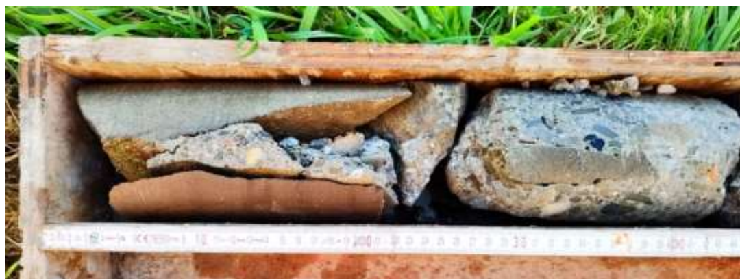
Obr. 11 JV3 – detail jádrového vývrtu 0 – 0,4 m
